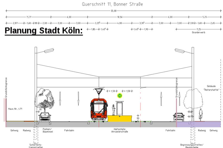
Keine gesonderten Außenbahnsteige, keine Mittelbahnsteige, sondern der Parkstreifen wird an die Gleise verschoben und im Bereich der Haltestellen zu Außenbahnsteigen ausgebaut. Dies ist nur ein Vorschlag der Bürger, erfordert aber schmalere Fahrbahnbreiten und den Verzicht auf eine fünfte Fahrspur in Linksabbiegebereichen.
